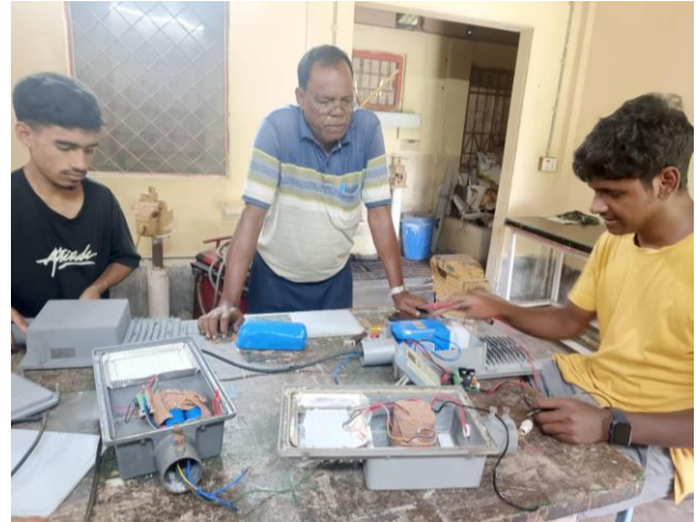
Figure 7 : Identification des composants électroniques défectueux des lampadaires solaires.
